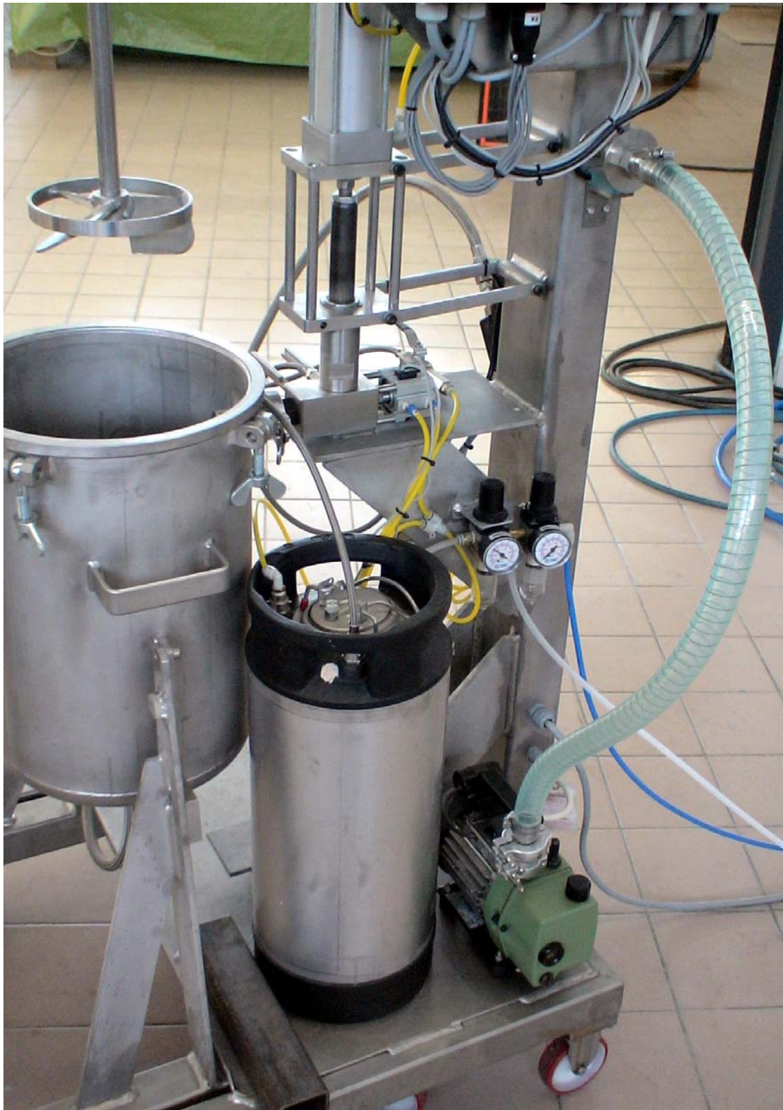
Vakuumpumpe, Reinigungstank, Förderpumpe und Materialtank
