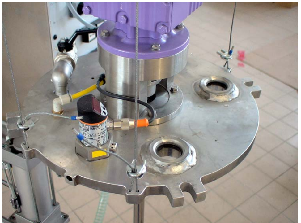
Tankdeckel mit Druck / Vakuumsensor, Rührwerk, Sichtgläser und Kugelhahn für den Vakuumananschluss
