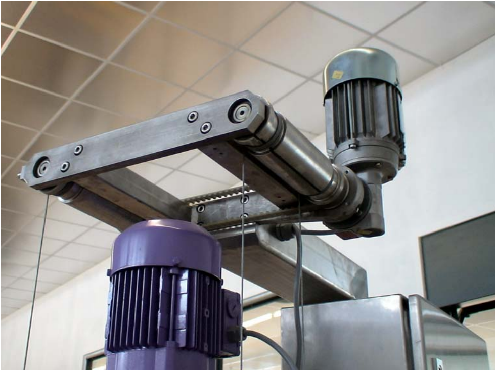
Seilzug zum Abheben des Rührwerkes vom Materialtank
