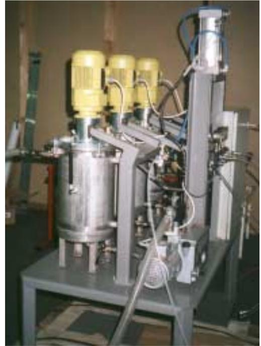
Rührwerke in geöffneter Position zum Auffüllen der Materialtanks
