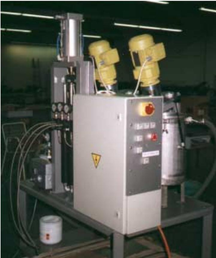
Frontplatte mit Bedienelemente und Steuerkasten
