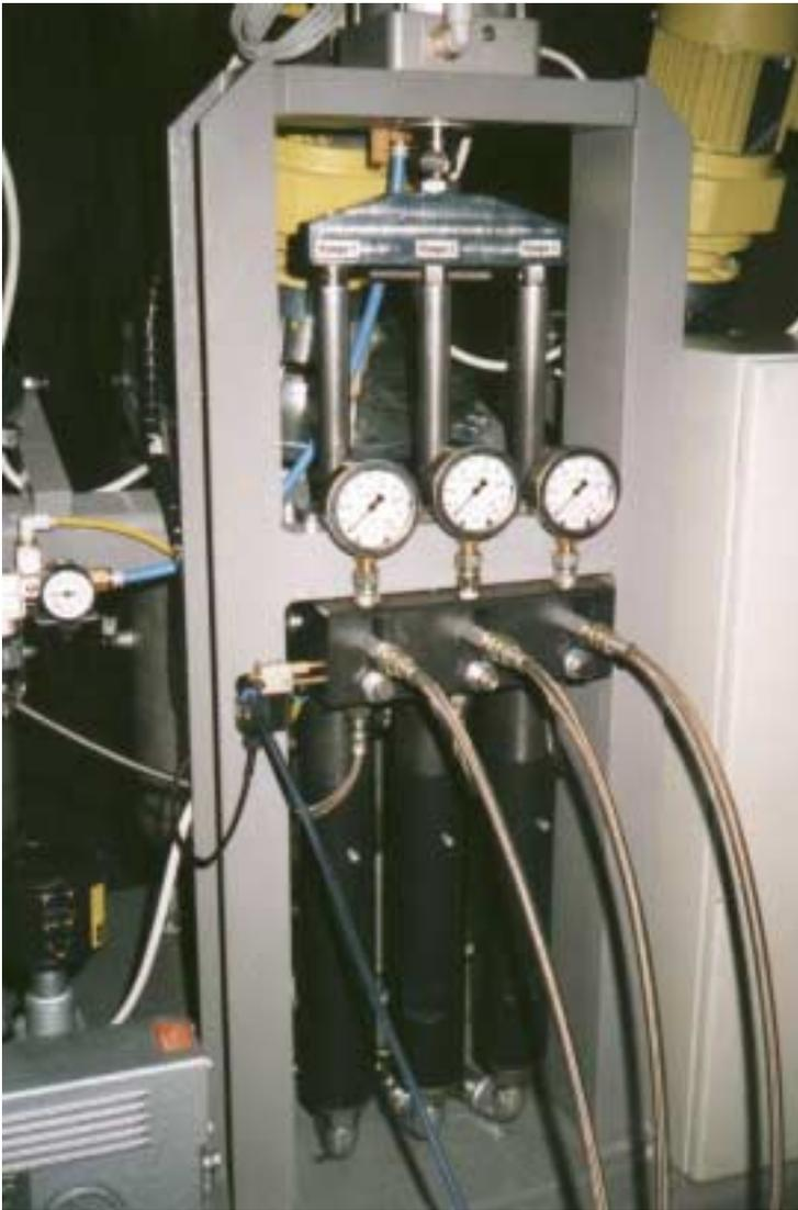
Förderpumpen mit Materialblock für Anschluss Rezirkulation, Druckanzeige und Materialschlauch zu Auslassventil
